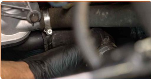
**15** Fixez le collier de serrage du tuyau de refroidissement. Utilisez une douille n° 7. Utilisez une clé à cliquet.
