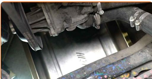
**5** Desserrez le collier de serrage du tuyau de refroidissement. Utilisez une douille n° 7. Utilisez une clé à cliquet.
