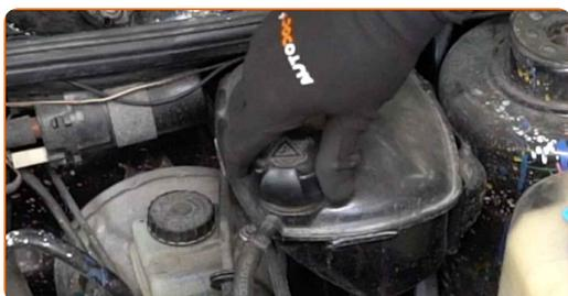
**22** Vissez le bouchon du réservoir de liquide de refroidissement.
