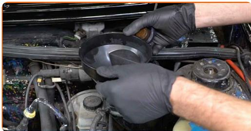
**18** Versez du liquide de refroidissement dans le réservoir.
