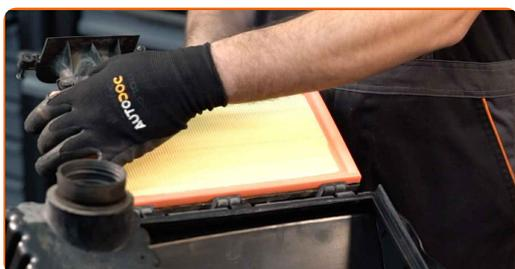
Remplacement : filtre à air – VW Saveiro V (5U8, 5U9). Les experts d'AUTODOC recommandent :
