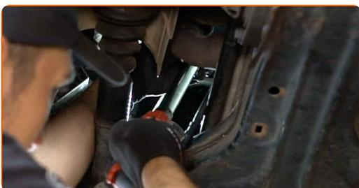
**13** Appliquez du produit sur le connecteur de la sonde lambda. Utilisez de la graisse diélectrique.
