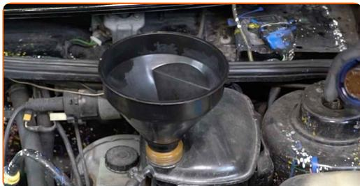
**36** Versez du liquide de refroidissement dans le réservoir.
