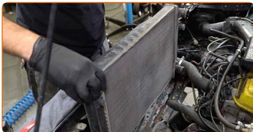
**18** Dévissez les fixations des conduits d'air du radiateur. Utilisez une douille n° 10. Utilisez une clé à cliquet.
