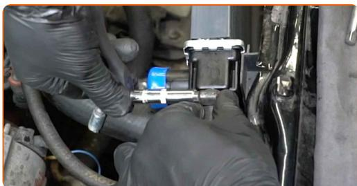
**27** Serrez les fixations du radiateur. Utilisez une douille n° 10. Utilisez une clé dynamométrique. Serrez-le jusqu'à 14 Nm.
