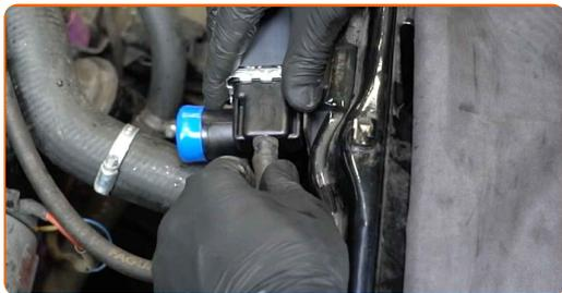
**26** Fixez le collier de serrage du tuyau de refroidissement. Utilisez une douille n° 7. Utilisez une clé à cliquet.
