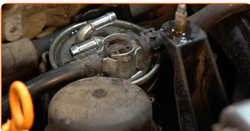
**11** Débranchez le tuyau du filtre à carburant.
