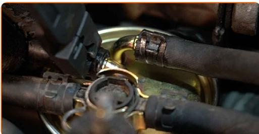
**20** Serrez les colliers de fixation des tuyaux de filtre à carburant. Utilisez des pinces pour colliers de serrage avec fixation.
