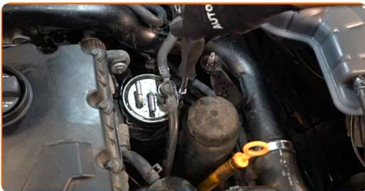
**10** Retirez la pièce de retenue du tuyau du filtre à carburant.
