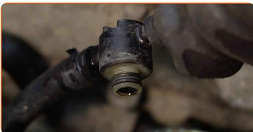
**17** Attachez le tuyau au filtre à carburant.
