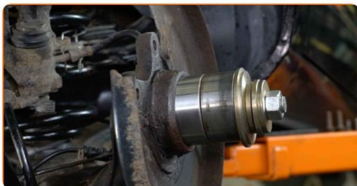
Remplacement : roulement de roue – VW Sharan VAN (7M). AUTODOC recommande :
