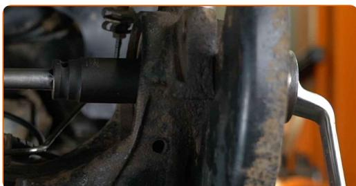
**41** Appliquez du produit sur la fixation du moyeu de roue. Utilisez de la graisse au cuivre.
