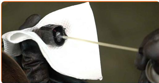
**57** Branchez le connecteur du capteur d'usure de plaquette de frein.
