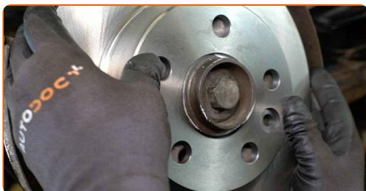
**45** Installez l'écrou de fixation.
