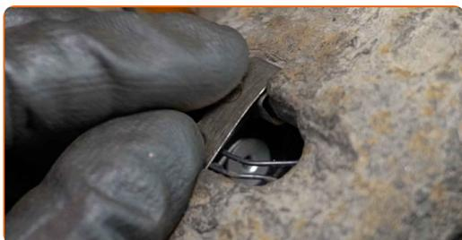
**59** Appliquez du produit sur la zone de contact entre le disque de frein et la jante. Utilisez du lubrifiant céramique.
