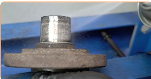
**37** Enfoncez le moyeu dans la fusée arrière. Utilisez un jeu d'extraction et d'installation de roulements.
