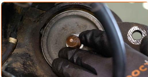
**39** Installez l'écrou de fixation.
