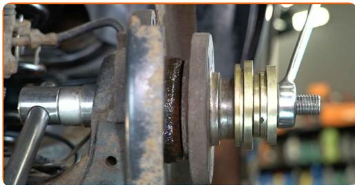
**38** Installez la rondelle élastique contenant un disque d'impulsion.
