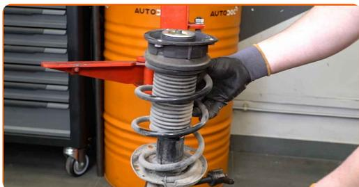
Remplacement : coupelle d'amortisseur – VW TIGUAN (AD1). Les professionnels recommandent :
