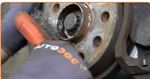
**63** Appliquez du produit sur la zone de contact entre le disque de frein et la jante. Utilisez du lubrifiant céramique.
