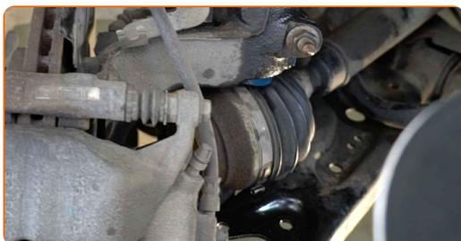
**48** Attachez le joint à rotule au bras de contrôle.
