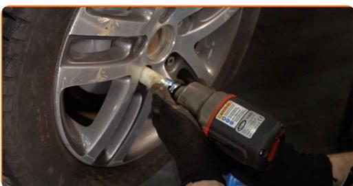
**41** Abaissez la voiture et serrez les boulons de roue en ordre croisé. Utilisez une clé dynamométrique. Serrez-le jusqu'à 120 Nm.
