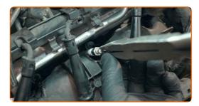
Serrez les bougies de préchauffage. Servez-vous de la douille de bougie d'allumage n°10. Utilisez une clé dynamométrique. Serrez-le jusqu'à 18 Nm.
