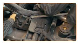
Détachez les connecteurs du faisceau de câbles du moteur. Utilisez un tournevis plat.
