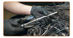
Appliquez du produit sur les bougies de préchauffage. Utilisez du lubrifiant céramique à haute température.
