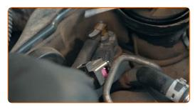
Débranchez les connecteurs de câblage des bougies de préchauffage. Utilisez des pinces à bec long.
