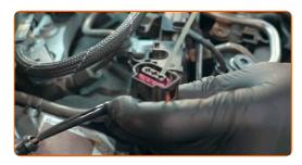
Branchez les connecteurs du faisceau de câbles du moteur.
