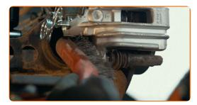
Dévissez l'attache de l'étrier de frein. Utilisez une clé mixte de No.15 Utilisez une douille n° 13. Utilisez une clé à cliquet.
