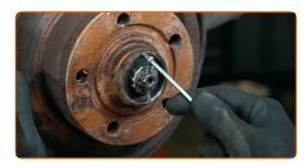
Dévissez l'écrou de moyeu. Utilisez une douille n° 24. Utilisez un porte-taraud.
