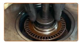
27 Installez le disque de frein assemblé avec le palier de moyeu de roue.
