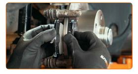
Installez l'étrier de frein et fixez-le. Utilisez une clé mixte de No.15 Utilisez une douille n° 13. Utilisez une clé dynamométrique. Serrez-le jusqu'à 35 Nm.
