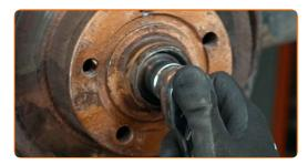
Retirez le disque de frein qui est assemblé avec le palier de moyeu de roue. Servez-vous d'un pied-de-biche.
