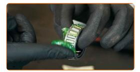
Appuyez sur le joint à huile intérieur du roulement de roue. Servez-vous d'un coffret de douilles et de roulements. Servez-vous d'un marteau.
