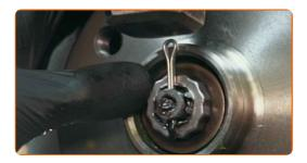
Installez le bouchon de l'écrou du moyeu. Servez-vous d'un maillet en caoutchouc.
