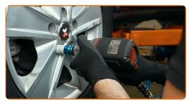
Abaissez la voiture et serrez les boulons de roue en ordre croisé. Servez-vous d'une douille à choc pour roue N°17. Utilisez une clé dynamométrique. Serrez-le jusqu'à 120 Nm.
