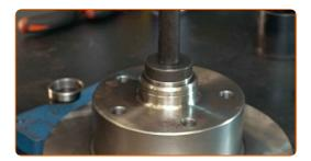
Appliquez du produit sur le palier de moyeu de roue. Servez-vous d'une graisse multi-usages.
