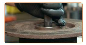
Retirez la bague intérieure du roulement du moyeu de la roue. Retirez le joint à huile intérieur du roulement de la roue. Utilisez un extracteur universel. Servez-vous de l'extracteur de moyeu à inertie.
