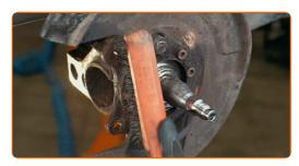
Faites sortir le palier du moyeu de roue. Servez-vous d'un coffret de douilles et de roulements. Servez-vous d'un marteau.
