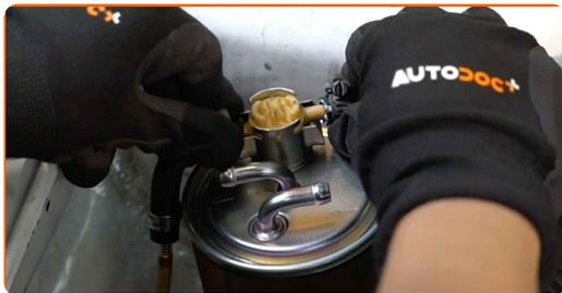
**13** Installez le clip de retenue de la conduite de carburant.
