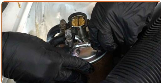
**18** Vissez la fixation reliant la conduite d'alimentation en carburant au carter du filtre à carburant. Utilisez une douille n° 7. Utilisez une clé à cliquet.
