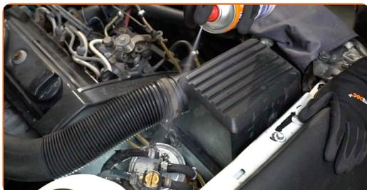
**4** Desserrez le support du filtre à carburant. Utilisez une douille n° 13. Utilisez une clé à cliquet.
