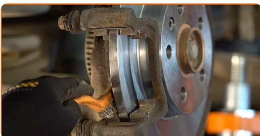
**Remplacement : plaquettes de frein – VW Transporter IV Van (70A, 70H, 7DA, 7DH). Les experts d'AUTODOC recommandent :**
