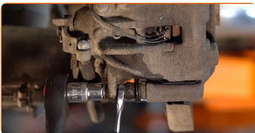
**10** Déconnectez le connecteur du capteur d'usure de plaquette de frein.
