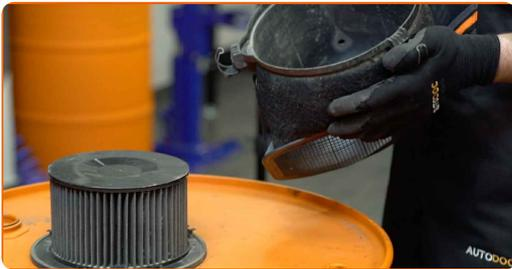
Remplacement : filtre d'habitacle – VW Transporter T4 Van (70A, 70H, 7DA, 7DH). Les professionnels recommandent :
