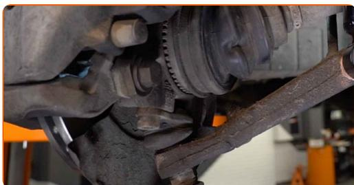
**25** Serrez l'attache inférieure de l'amortisseur. Utilisez une douille n° 21. Utilisez une clé dynamométrique. Serrez-le jusqu'à 120 Nm.
