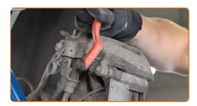
Dévissez l'attache de l'étrier de frein. Utilisez une douille n° 12. Utilisez une clé à cliquet.
