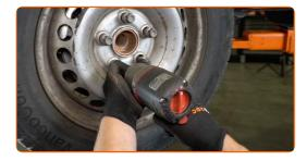
Abaissez la voiture et serrez les boulons de roue en ordre croisé. Servez-vous d'une douille à choc pour roue N°19. Utilisez une clé dynamométrique. Serrez-le jusqu'à 180 Nm.
