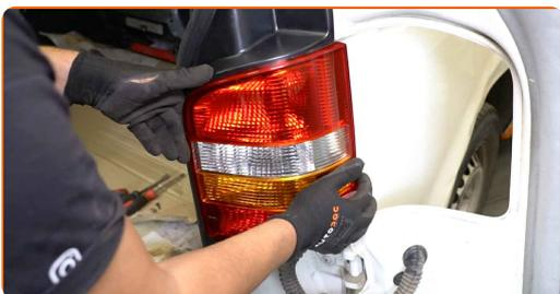
Remplacement : feu arrière – VW Transporter V Minibus (7HB, 7HJ, 7EB, 7EJ, 7EF, 7EG, 7HF, 7EC). Conseil :
