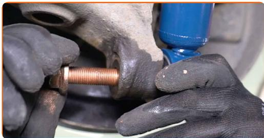
**18** Serrez l'attache inférieure de l'amortisseur. Utilisez une clé mixte de No.21 Utilisez une douille n° 21. Utilisez une clé dynamométrique. Serrez-le jusqu'à 120 Nm.+90°
