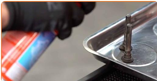
**26** Appliquez du produit sur les boulons de guidage de l'étrier de frein. Appliquez la graisse pour les boulons de guidage de l'étrier de frein.
