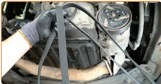
Remplacement : courroie poly V – Nissan X Trail T30. Les experts d'AUTODOC recommandent :
