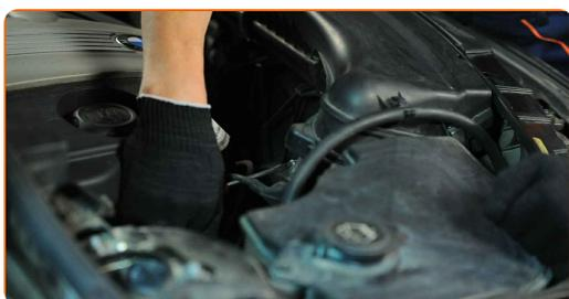
4 Débranchez le connecteur du débitmètre d'air. Utilisez un tournevis plat.
