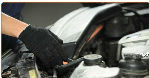
**12** Appuyez sur les attaches du couvercle du filtre à air pour le remettre en place.
