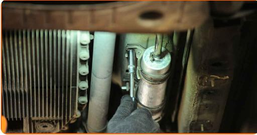
17 Vissez le support de montage du filtre à carburant. Utilisez une douille n° 10. Utilisez une clé à cliquet.
