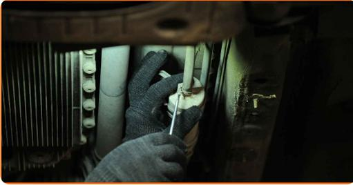
Remplacement : filtre à carburant – BMW X3 E83. AUTODOC recommande :
