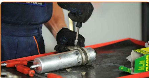
Remplacement : filtre à carburant – BMW X3 E83. Les professionnels recommandent :
