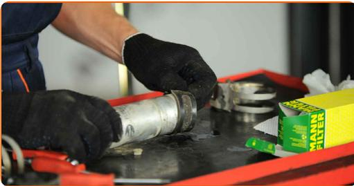
10 Installez le joint en caoutchouc. Utilisez un tournevis plat.
