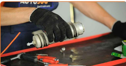
8 Dévissez la fixation du support pour filtre à carburant. Utilisez la mèche Torx T20. Utilisez une clé à cliquet.
