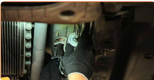
16 Serrez le collier de serrage du tuyau du filtre à carburant. Utilisez un tournevis plat.
