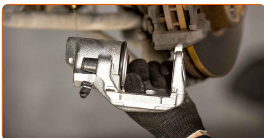
**22** Serrez la fixation reliant la conduite de freinage à l'étrier de frein. Utilisez une clé polygonale ouverte #14. Utilisez une clé dynamométrique. Serrez-le jusqu'à 18 Nm.
