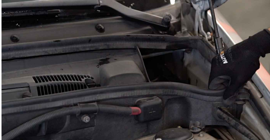
3 Retirez le joint en caoutchouc.
