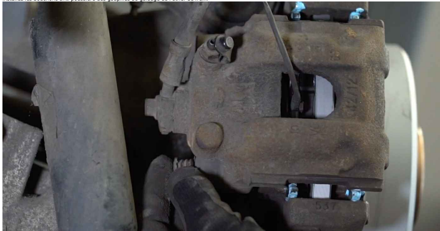
24 Installez le ressort de retenue de l'étrier de frein.
