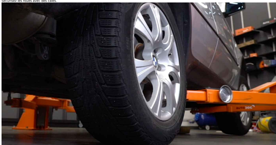
6 Desserrez les boulons de fixation de la roue. Servez-vous d'une douille à choc pour roue N°19.
