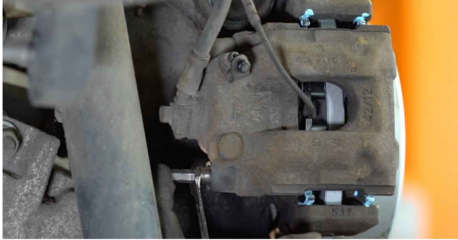
23 Installez les bouchons anti-poussière des goupilles de guidage de l'étrier de frein.
