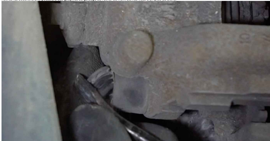
12 Dévissez l'attache de l'étrier de frein. Utilisez la clé HEX n° H7. Utilisez une clé à cliquet.
