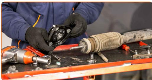
**29** Serrez l'écrou de la tige de l'amortisseur. Utilisez une clé mixte de No.19. Servez-vous d'une clé ajustable. Utilisez une clé dynamométrique. Serrez-le jusqu'à 25 Nm.
