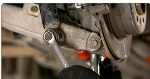
**48** Nettoyez les fixations de l'amortisseur. Utilisez de la graisse au cuivre.
