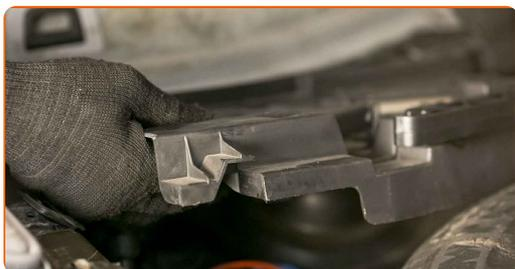
**21** Retirez le bouchon de protection du support de l'amortisseur. Utilisez un tournevis plat.
