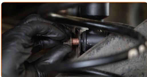
**47** Serrez l'attache inférieure de l'amortisseur. Utilisez une clé mixte de No.21 Utilisez une douille n° 21. Utilisez une clé dynamométrique. Serrez-le jusqu'à 127 Nm.
