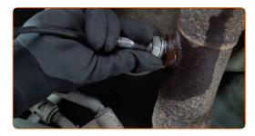
Serrez la fixation de la sonde lambda. Utilisez une clé mixte de No.22 Utilisez une clé dynamométrique. Serrez-le jusqu'à 41 Nm.
