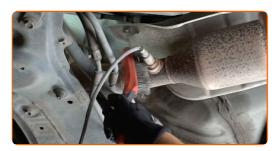
Dévissez la fixation de la sonde lambda. Utilisez une douille à sonde lambda de 22 mm. Utilisez une clé à cliquet.
