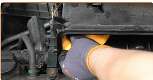
**6** Retirez l'élément filtrant du couvercle du filtre à air.
