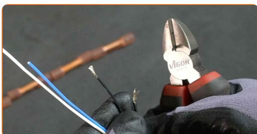
**14** Placez la gaine thermorétractable sur le câblage de la sonde lambda.
