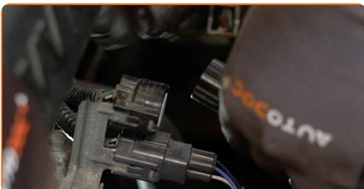
**4** Détachez le collier de serrage pour libérer le faisceau de câbles de la sonde lambda. Utilisez un tournevis plat.
