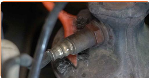
**6** Dévissez la fixation de la sonde lambda. Utilisez une clé polygonale ouverte #22. Utilisez une clé à cliquet.
