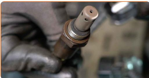
**8** Faire un taraudage pour la nouvelle sonde lambda. Utilisez un taraud. Utilisez une clé à cliquet.
