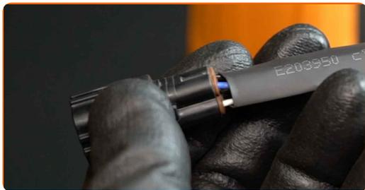
**19** Rétractez la gaine thermorétractable. Utilisez un pistolet thermique.
