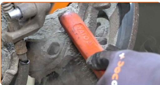
**13** Dévissez les fixations du support d'étrier de frein. Utilisez une douille n° 14. Utilisez une clé à cliquet.
