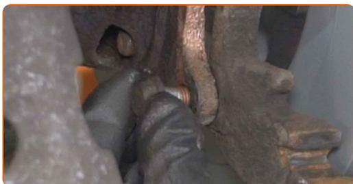
**23** Serrez les fixations du support d'étrier de frein. Utilisez une douille n° 14. Utilisez une clé dynamométrique. Serrez-le jusqu'à 57 Nm.
