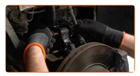
Vissez la fixation qui relie la jambe d'amortisseur à la fusée d'essieu. Utilisez une clé mixte de No.18 Utilisez une douille n° 18. Utilisez une clé à cliquet.
