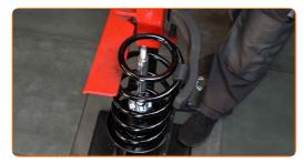
Installez la coupelle, le manchon et la butée de suspension sur l'amortisseur.
