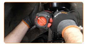
Serrez la fixation reliant la biellette à l'amortisseur. Utilisez une douille n° 19. Utilisez une clé dynamométrique. Serrez-le jusqu'à 60 Nm.
