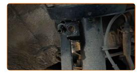
Débranchez les fils du capteur d'ABS.
