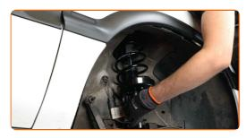
Vissez l'attache supérieure du support de l'amortisseur. Ne serrez pas trop.
