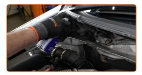
Devissez la fixation supérieure du support d'amortisseur. Utilisez une clé mixte de No.18 Utilisez la clé HEX n° H6. Utilisez une clé à cliquet.
