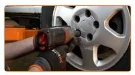
Abaissez la voiture et serrez les boulons de roue en ordre croisé. Servez-vous d'une douille à choc pour roue N°19. Utilisez une clé dynamométrique. Serrez-le jusqu'à 110 Nm.
