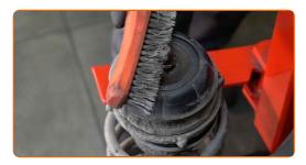
Retirez l'écrou de la tige de piston de l'entretoise. Utilisez la clé HEX n° H6. Utilisez une douille n° 18. Utilisez une clé à cliquet.
