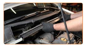
Vissez les fixations de la partie inférieure du tablier d'auvent. Utilisez une douille n° 10. Utilisez une clé à cliquet.
