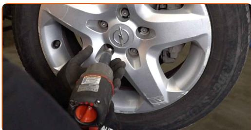
Remplacement : disques de frein – Opel Zafira B A05. AUTODOC recommande :
