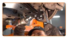
Serrez l'attache du joint rotule. Utilisez une douille n° 19. Utilisez une clé mixte de No.17. Utilisez une clé dynamométrique. Serrez-le jusqu'à 50 Nm.
