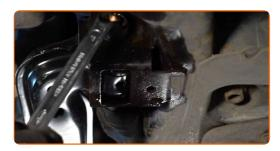
Serrez la fixation arrière du bras de suspension. Utilisez une clé mixte de No.18 Utilisez une douille n° 18. Utilisez une clé dynamométrique. Serrez-le jusqu'à 90 Nm.+90°
