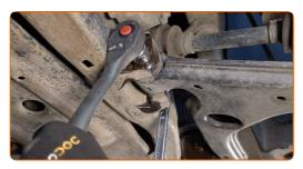
Desserrez la fixation arrière du bras de suspension. Utilisez une douille n° 18. Utilisez une clé mixte de No.18. Utilisez une clé à cliquet.
