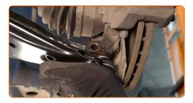
Installez l'écrou de fixation.
