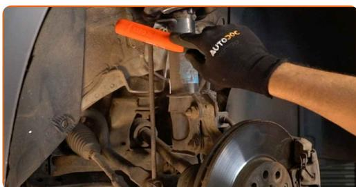
**14** Dévissez l'écrou et retirez la barre stabilisatrice de l'entretoise de l'amortisseur. Utilisez une clé mixte de No.19. Utilisez une douille n° 19. Utilisez une clé à cliquet.
