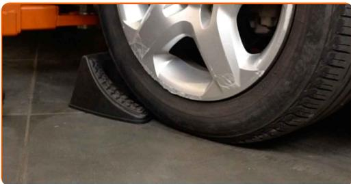
**9** Desserrez les boulons de fixation de la roue. Servez-vous d'une douille à choc pour roue N°17.
