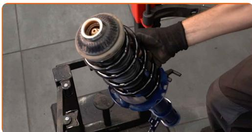
42 Lubrifiez la barre d'amortisseur. Utilisez de la graisse au cuivre.
