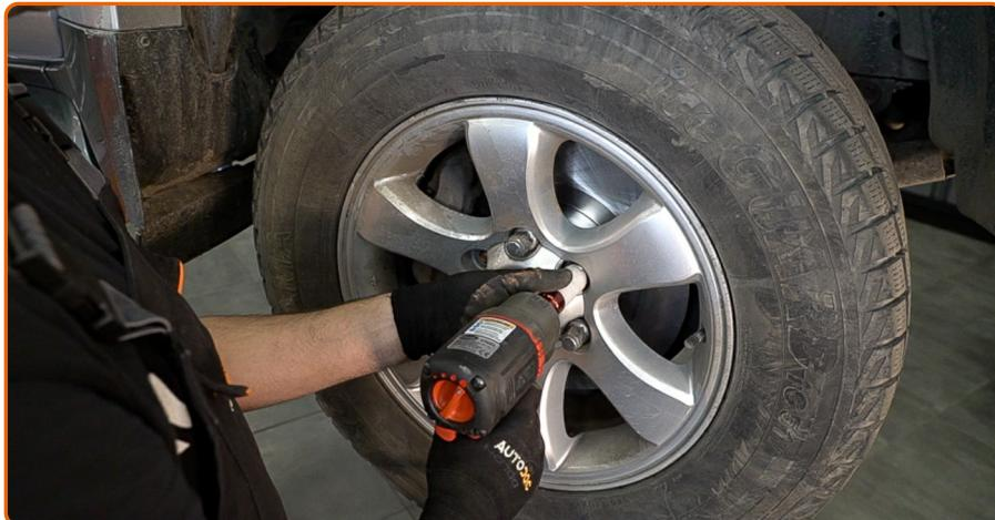
Vissez les boulons de la roue. Servez-vous d'une douille à choc pour roue N°21.
