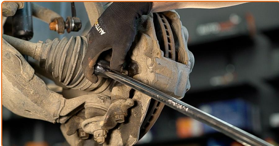
Dévissez l'attache de l'étrier de frein. Utilisez une douille n° 17. Utilisez un porte-taraud.
